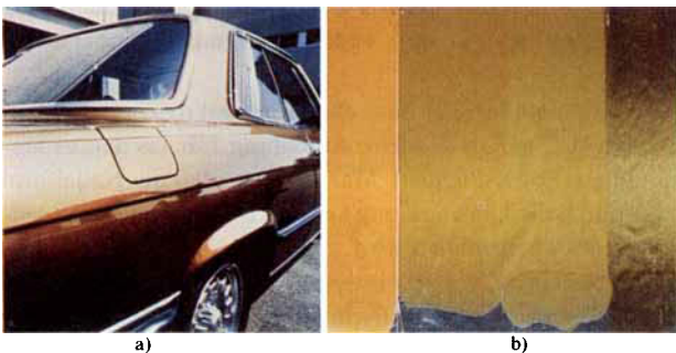
Abb. 12. a) Hell-Dunkel-Effekt bei Metallic-Lackierungen. b) Hell-Dunkel-Effekt in Abhängigkeit von der Teilchengröße des Pigments. Links Lackfilmstreifen mit deckendem Pigment (größere Teilchen), rechts mit transparentem Pigment (sehr kleine Teilchen), dazwischen zwei Lackfilmstreifen mit halbtransparenten Pigmenten.
