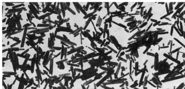
Abb. 14. Elektronenmikroskopische Aufnahme eines CrO 2 -Pigments. 14 mm auf der Abbildung entsprechen 1 µm.
